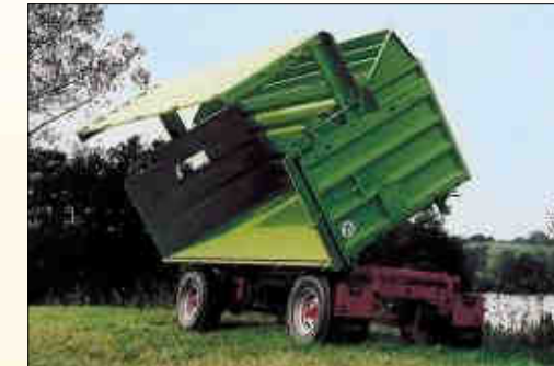
HW 80 többcélú felépítmény: 9.változat. Kétoldalra billenő változat
