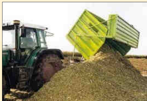
Kombinált felépítmény: 4.2 Változat, silókiivitel, 1800 mm magas, ürítés folyamat
