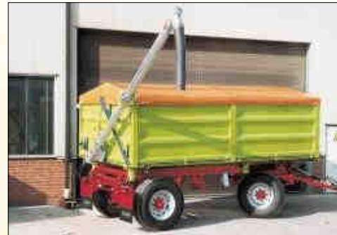
HW 80 háromoldalra billenő, T 31 G4 feltöltő csigával Térfogat: 14,6 m 3
