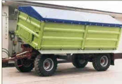
HW 80 kétoldalra billenő, felépítmény 4. változat, rászerelt csúszdával garatra való ürítéshez
