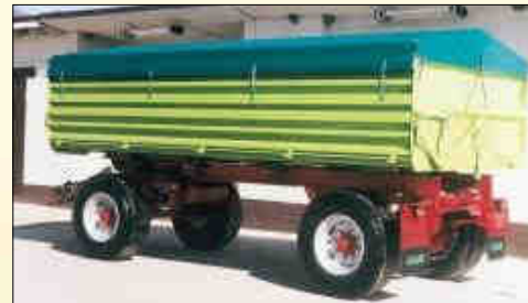
3.1. változat Felépítmény méretei: hossz: 5200 mm, szélesség: 2340 mm, magasság: 950 mm, térfogat: 11,6 m 3
