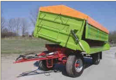
A HW 80 és 180 pótkocsi alsó oldalfalának hidraulikus nyitása, különösen alkalmas gabona ürítésére fogadógaratba, a mellészóródás elkerülésére a kétoldali határoló szegmens által. 4.1. változat
