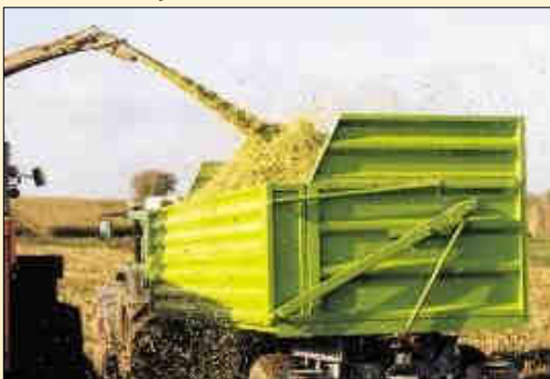
Kombinált felépítmény: 4.2 Változat, silókiivitel, 1800 mm magas, töltési folyamat
