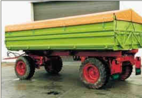
A hagyományos billenőplató, oldalfalak, nyitószerkezet, 1. változat Platóméret: 5200 x 2340 mm Térfogat: 10,7 m 3
