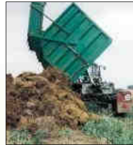
4.2. változat hidraulikus oldalnyitással istállótrágya billentéskor
