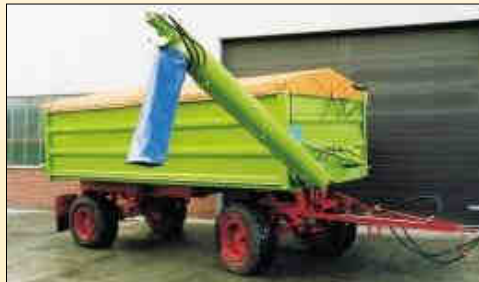
HW 80 vetőmag és műtrágya feltöltővel, 6.b változat 120 cm oldalmagasság, csiga munkahelyzetben
