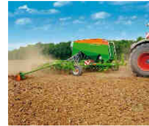
Az új Cayena típusú késes-csoroszlás vetőgép a 6 m munkaszélességével különösen a kemény és kavicsos talajon és a száraz régiókban mutatja erősségeit.
