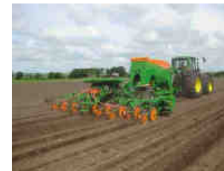
Az EDX 6000-T típusú új vontatott szemenkénti vetőgéppel a területteljesítményt a hagyományos technikával szemben akár 50%-kal is növelni lehet, mégpedig összehasonlítható vetési minőség mellett.
