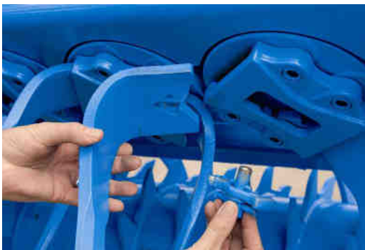
LEMKEN Zirkon 8, Austausch der Schnellwechselzinken
