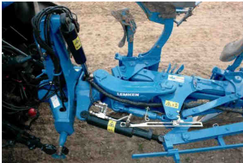
Elektrohydraulische wentelsysteeminstelling van de Juwel aanbouwploeg
