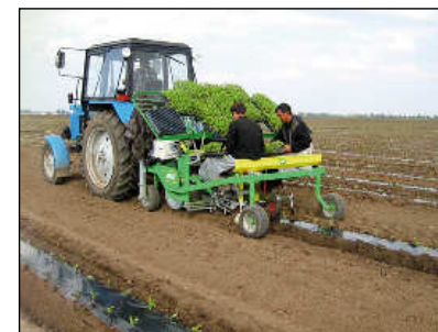
Hortech Due Manual palántázógép 2 soros változata
