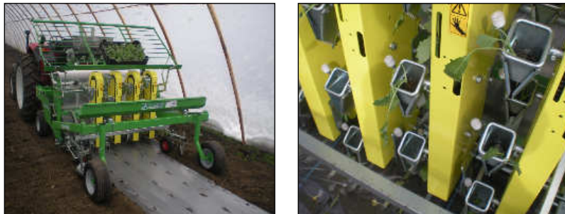
A palánták fólián keresztül, a talajba történő juttatása a palántázó egység csészéi által történik
