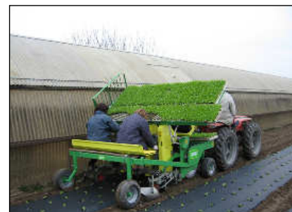
Hortech Due Manual palántázógép 4 soros változata
